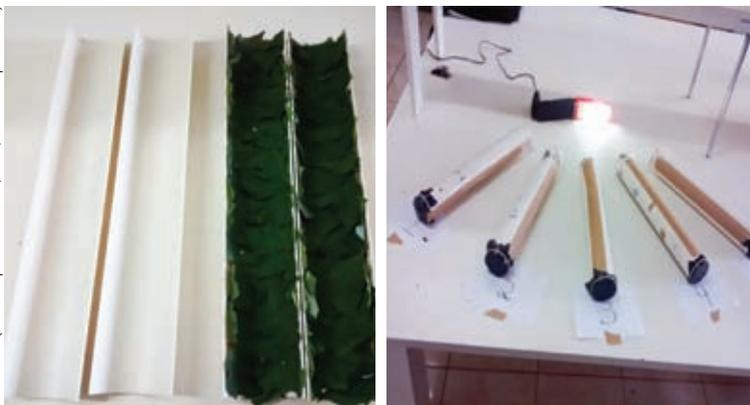
**Figura 3.** Metodologia utilizada nos testes de caminamento de adultos do bicudo em folhas tratadas com inseticidas
