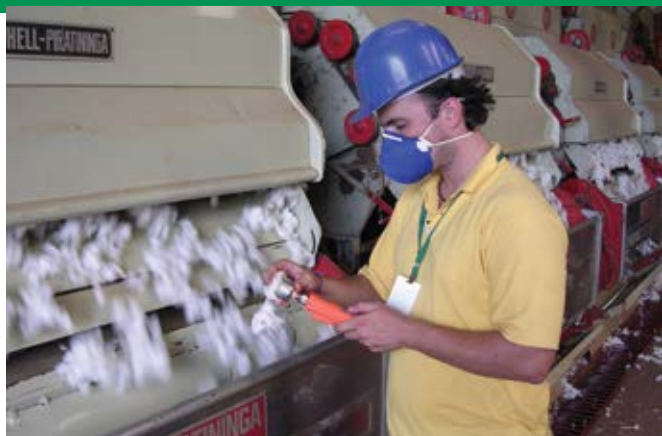
Figura 9. Controle manual da umidade do algodão em caroço nos alimentadores. (Fonte: Cotimes, 2005)
