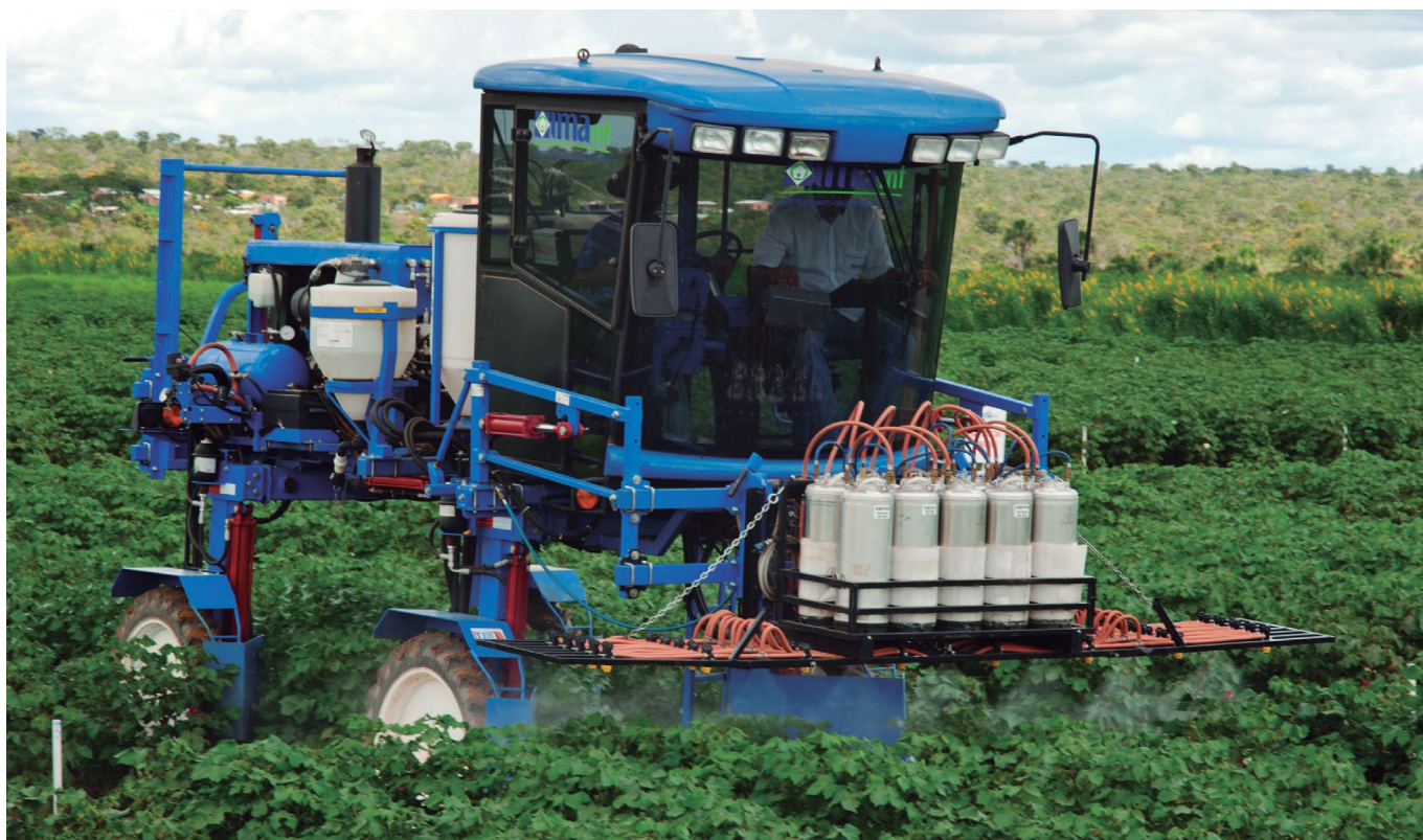
Figura 1. Pulverizador auto-propelido de pesquisa Lee Spider Spray Trac, modelo 4460-DL2-60. (Foto: J. Medeiros)
